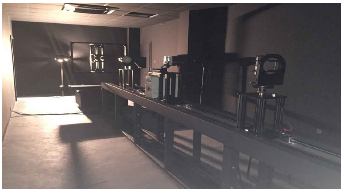
IEC62471 光生物辐射安全测试系统测试图
